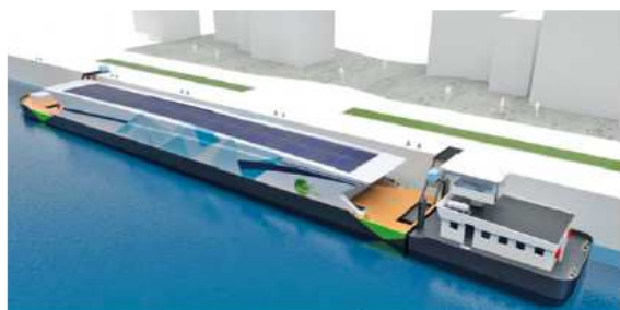
Le projet Green Deliriver est une barge qui intègre un système de propulsion biogaz/électrique pour acheminer des déchets depuis Paris vers la vallée de Seine par voie fluviale plutôt que par la route.
